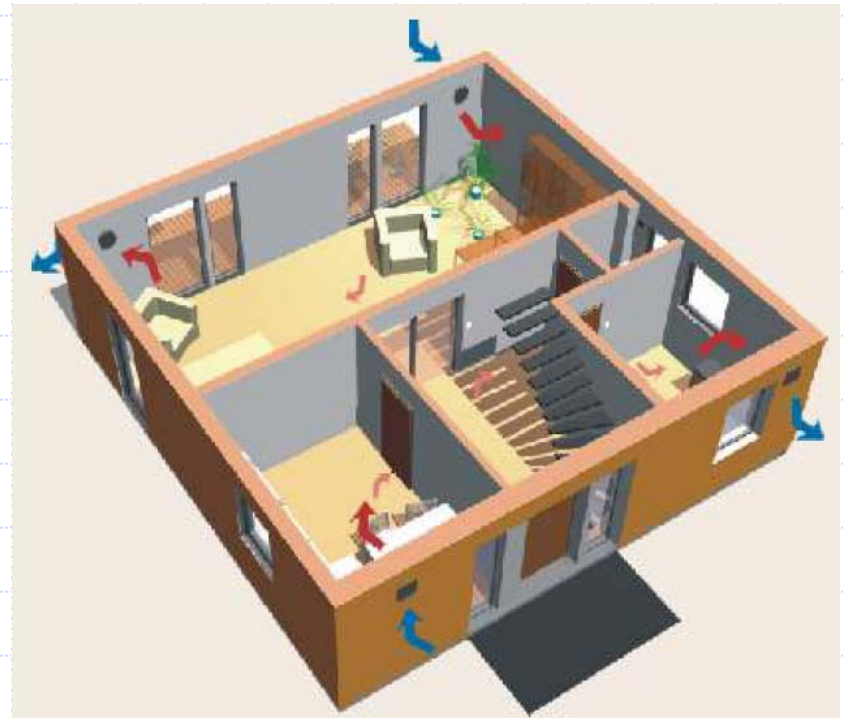
dezentrale Lüftungsanlage (Sanierung)
